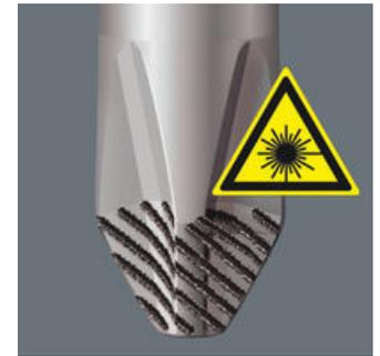
Tramite un raggio laser concentrato, si crea una superficie di strutturazione a spigolo vivo. La lama Lasertip della Wera si aggrappa saldamente nella testa della vite evitando che ne slitti fuori. Adatto per viti a taglio, Phillips e Pozidriv.
