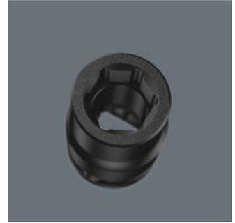
Il profilo esagonale facilita la trasmissione di elevate coppie e sollecita in modo minore il bordo del dado e/o la testa della vite rispetto ad un profilo poligonale. Cricchetti con meccanismo a dentatura fine, grazie al loro ridotto angolo di richiamo, rendono superfluo l'impiego di un profilo poligonale, anche in spazi ristretti.
