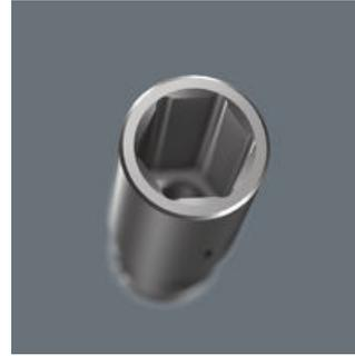
Il profilo esagonale facilita la trasmissione di elevate coppie e sollecita in modo minore il bordo del dado e/o la testa della vite rispetto ad un profilo poligonale. Cricchetti con meccanismo a dentatura fine, grazie al loro ridotto angolo di richiamo, rendono superfluo l'impiego di un profilo poligonale, anche in spazi ristretti.
