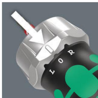
Il meccanismo a cricchetto con dentatura fine consente un angolo di richiamo ridotto. Grazie all'anello di inversione è possibile cambiare la direzione di avvitamento destra/bloccato/sinistra. Attacco magnetico dell'inserto per inserti da 1/4" esagonali secondo DIN ISO 1173-C 6,3 e della serie Wera 1.
