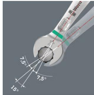
Grazie al lato a forchetta orientabile di 7,5°, alla geometria a doppio esagono e a un metodo di applicazione adattato (fissaggio, avvitatura, rotazione, riattacco, avvitatura, rotazione, ecc.), possono essere utilizzati anche in caso di avvitiamenti in cui l'angolo di rotazione è inferiore a 30°.
