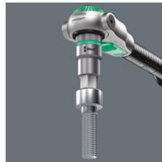
Le viti ad esagono cavo s'incastrano sull'insero-bussola grazie ad una sfera a molla sull'insero. Specialmente utile negli spazi difficilmente raggiungibili nei quali non si può usare la seconda mano per trattenere la vite.
