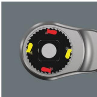
Ingranaggio con doppio nottolino. Conferisce ai 38 denti l'effetto di una dentatura fine a 76 denti, con angolo di richiamo di soli 4,7°.
