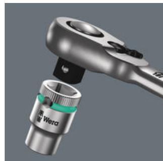
Il bloccaggio a sfera garantisce una sicura tenuta della bussola e degli accessori rendendo in questo modo il lavoro di avvitamento ancora più sicuro. Per cambiare l'utensile basta una breve pressione sul pulsante a scatto.
