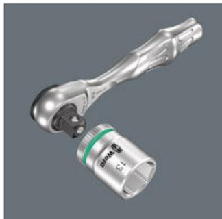
Il cricchetto Zyklop Mini 3 è l'utensile ideale per avvitare in spazi ristretti. La dentatura fine (60 denti) permette un angolo di richiamo molto ridotto di soli 6°; la rotella zigrinata consente avvitiamenti rapidi, anche dove non c'è spazio per la rotazione.
