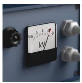
Solo il collaudo dell'utensile con prova di resistenza a 10.000 Volt, da all'utilizzatore la certezza assoluta che il suo giravite sia stato testato rispetto alla sua caratteristica più importante, cioè il suo isolamento. I giravite VDE della Wera vengono collaudati uno ad uno. Il lavoro sicuro fino a 1.000 Volt è pertanto garantito.
