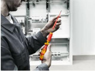
Gli assortimenti Kraftform Kompakt VDE contengono una impugnatura portalama, come anche lame intercambiabili isolate che si possono cambiare senza utensili speciali.
