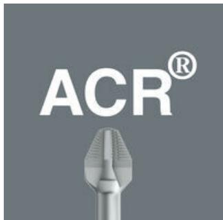
ACR® signifie Anti-Cam-Out Ribs. La pointe des embouts ACR® est munie de stries pour empêcher l'embout de riper hors de la vis. ACR® est un sigle déposé par la société Phillips Screw Company
