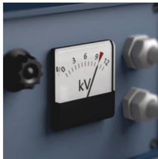
Le contrôle pièce à pièce des outils à 10 000 volts selon IEC 60900 garantit un travail en toute sécurité sous tension jusqu'à 1 000 volts.
