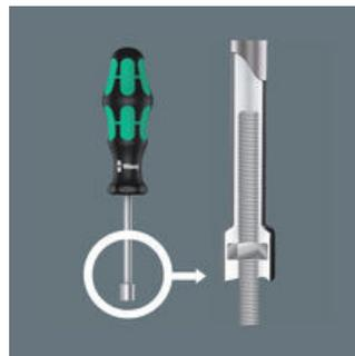
Les tournevis à lame creuse sont utiles pour les vissages sur tiges filetées. En effet, la tige filetée pénètre dans la tige creuse du tournevis, ce qui permet d'actionner l'écrou.
