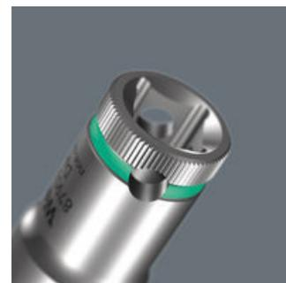
Douilles pour usage manuel et sur machine (ISO 2725-partie 3) pour une utilisation tant en mode manuel que mécanique. Repéreur d'outils Take it easy avec code couleur en fonction de la taille pour trouver rapidement et facilement l'outil nécessaire. Facile à saisir même avec les mains grasses. Avec gorge à bille. Pour vis à tête hexagonale et écrous hexagonaux. En chrome-vanadium, chromé mat.
