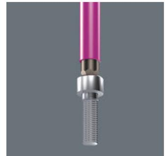
La retenue de la vis à six pans sur la clé mâle coudée est assurée par une bille. Particulièrement utile dans les espaces de travail difficile d'accès, où l'on ne peut pas se servir de l'autre main pour maintenir la vis.
