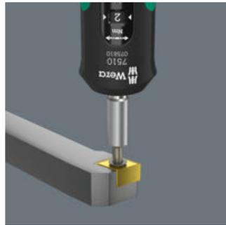
Le jeu d'outils est spécialement conçu pour le vissage de plaquettes de coupe en carbure de tungstène. Le tournevis dynamométrique Safe-Torque Speed 7510 avec ses cinq couples au choix recommandés par les principaux fabricants d'outils en carbure de tungstène permet un serrage contrôlé des plaquettes de coupe remplaçables.
