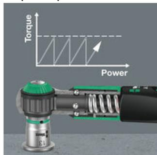
La clé dynamométrique Safe-Torque A 1 est équipée d'un mécanisme de débrayage. L'outil ne peut pas dépasser le couple réglé de sorte que l'application d'un couple trop élevé est exclue.
