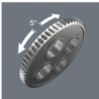
La clé dynamométrique Safe-Torque à fine denture (72 dents) a un faible angle de reprise de seulement 5°. La reprise minimale permet un travail rapide et précis quelle que soit la complexité d'accès.
