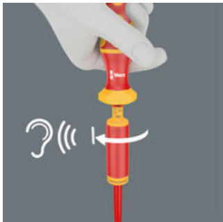
Déclic parfaitement audible/tangible lorsque la valeur de couple paramétrée est atteinte.
