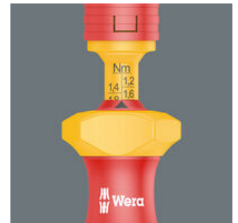
Bonne lisibilité de l'échelle de valeurs. Précision de mesure +/- 6 % conformément à la norme EN ISO 6789.
