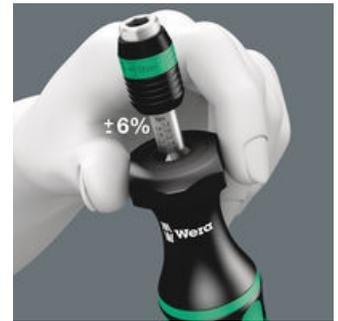
Précision de mesure  $\pm 6\%$  (article 1430 :  $\pm 10\%$ ) conformément à la norme DIN EN ISO 6789. Déclat parfaitement audible/tangible lorsque la valeur de couple paramétrée est atteinte.
