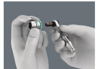
Des embouts et des douilles. Les embouts sont emboîtables directement. Il est possible aussi d'emboîter d'abord un porte-embouts pour guider l'embout. Celui-ci sert alors également de rallonge avec douille de guidage à course libre. Pour les douilles, un adaptateur 1/4" hexagonal sur carré est nécessaire, par ex. Wera 870/1 (inclus dans le Bit-Check et les différents mini-cliquets à embouts).
