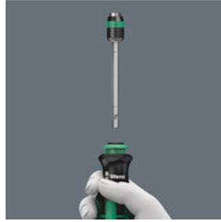
Une nouvelle pression énergique sur la douille permet de libérer le mécanisme de déclenchement par franchissement de la résistance de blocage (déclat audible et tangible). La lame télescopique peut être retirée et insérée comme adaptateur machine ou remise dans sa position initiale.
