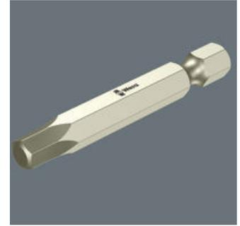
L'emploi d'embouts en acier inoxydable permet de prévenir l'apparition de rouille erratique sur les vis ou les surfaces inox. Un phénomène dû avant tout à la limaille produite lors du vissage avec des outils en acier ordinaire. Ces particules de limaille d'acier, sous l'action de l'oxygène, entraînent la rouille.
