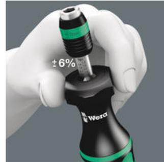
Réglage aisé de la valeur de couple requise, à la main. Précision de mesure  $\pm 6\%$  conformément à la norme EN ISO 6789. Déclat parfaitement audible/tangible lorsque la valeur de couple paramétrée est atteinte.
