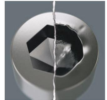
Le problème des vis à six pans creux tient à la minceur des surfaces d'appui sur lesquelles s'opère la transmission de force depuis l'outil. Résultat : la tête de vis peut être détruite. Les outils Hex-Plus possèdent des surfaces d'appui plus larges qui empêchent les têtes de vis de s'arrondir. Bon à savoir : les outils Hex-Plus rentrent dans tous les modèles de vis à six pans creux standard !
