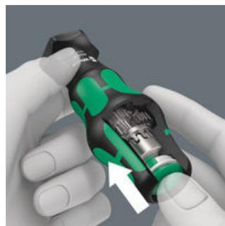
La fonction Turbo peut être activé ou désactivé par simple pression selon les besoins. Désactiver en cas de vissage dans le bois, de couple élevé ou pour ajuster le serrage.
