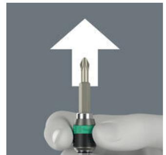
Pour échanger l'embout, il suffit de faire coulisser la douille vers l'avant : le mécanisme à ressort décolle l'embout de l'aimant et déverrouille l'outil. L'embout peut être retiré sans problèmes. Particulièrement utile: retrait des embouts même de tout petit taille sans aucun outil auxiliaire.
