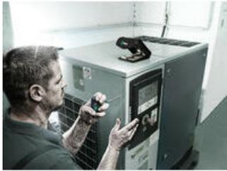
Le mécanisme de cliquet du manche en T 416 RA est entièrement intégré dans le manche. La forme compacte de l'outil offre une grande maniabilité.
