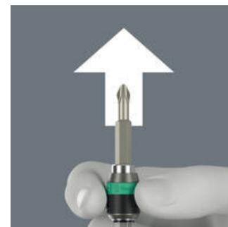
Pour échanger l'embout, il suffit de faire coulisser la douille vers l'avant : le mécanisme à ressort décolle l'embout de l'aimant et déverrouille l'outil. L'embout peut être retiré sans problèmes. Particulièrement utile: retrait des embouts sans même de tout petit calibre sans aucun outil auxiliaire.
