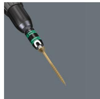
La douille magnétique sur l'anneau du Rapidaptor offre un maintien à toute épreuve des vis même longues et lourdes, permettant une mise en place rapide. Il n'est plus nécessaire de maintenir la vis au début du vissage, opération parfois dangereuse et physiquement pénible. Idéal aussi pour les travaux en hauteur.
