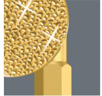
Les minuscules particules de diamant garnissant la pointe de l'outil viennent littéralement "mordre" dans la vis et offrent un positionnement parfaitement ajusté et antidérapant dans la tête de cette dernière. Ce positionnement sûr ménage la vis. Les forces de rejet ("cam-out") qui obligent l'utilisateur à exercer une pression élevée sur la vis sont considérablement réduites.
