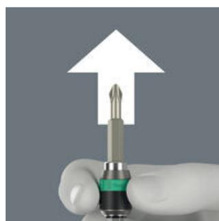
Pour échanger l'embout, il suffit de faire coulisser la douille vers l'avant : le mécanisme à ressort décolle l'embout de l'aimant et déverrouille l'outil. L'embout peut être retiré sans problèmes. Particulièrement utile: retrait des embouts même de tout petit taille sans aucun outil auxiliaire.
