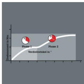
Le fonctionnement du système BiTorsion est basé sur la combinaison de deux éléments amortissant qui absorbent les chocs. Les embouts, tout comme les porte-embouts, présentent une zone de torsion jouant le rôle d'amortisseur qui évacue hors de la pointe d'attaque l'énergie cinétique survenant lors des pics de contrainte.
