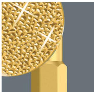
Les minuscules particules de diamant garnissant la pointe de l'outil viennent littéralement "mordre" dans la vis et offrent un positionnement parfaitement ajusté et antidérapant dans la tête de cette dernière. Ce positionnement sûr ménage la vis. Les forces de rejet ("cam-out") qui obligent l'utilisateur à exercer une pression élevée sur la vis sont considérablement réduites.
