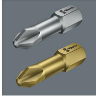
Les embouts Torsion (T) sont des embouts avec en plus une zone de torsion. Ces embouts permettent d'amortir les pics de couple dans cette zone évitant ainsi l'usure précoce ; les embouts gagnent en longévité.
