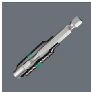
Les adaptateurs BiTorsion de Wera possèdent un ressort de torsion qui absorbe les pics de contrainte mineurs lors du vissage. Leur utilisation conjointe avec les embouts BiTorsion et leur zone de torsion prolongent sensiblement la durée de vie de l'outil. Les adaptateurs BiTorsion Wera peuvent toutefois aussi être employés avec des embouts conventionnels.
