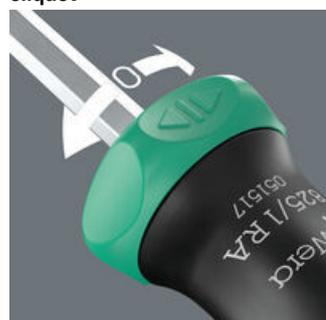
Inversion intuitive du mécanisme de cliquet. Si on tourne la bague rotative vers la droite, le vissage s'effectue vers la droite. Si on le tourne vers la gauche, le vissage s'effectue vers la gauche. La position 0 permet de désactiver le mécanisme de cliquet pour les travaux de précision.
