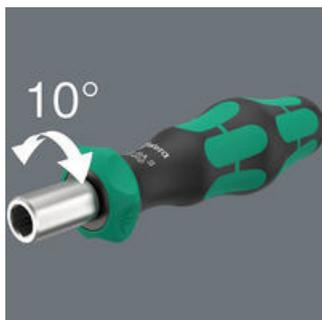
Le cliquet intégré à fine denture (36 dents) avec un angle de reprise de 10° simplifie et accélère le vissage. Plus besoin de désengager et repositionner l'outil.
