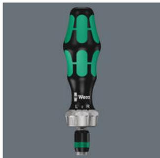
Tournevis à cliquet, fine denture pour un faible angle de reprise, bague d'inversion (droite, fixe, gauche), couple maximal allant jusqu'à 50 newtons-mètres ; admission six pans creux 1/4" avec technologie Rapidaptor offrant les fonctions "rapid-in", "rapid-out", "rapid-spin", "chuck-all" et "single-hand" pour un échange éclair des embouts, magnétique, convenant pour embouts à emmanchement hexagonal 1/4" selon DIN ISO 1173-C 6,3 et E 6,3 et des séries 1 et 4 Wera
