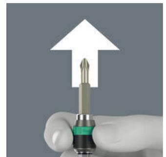
Pour échanger l'embout, il suffit de faire coulisser la douille vers l'avant : le mécanisme à ressort décolle l'embout de l'aimant et déverrouille l'outil. L'embout peut être retiré sans problèmes. Particulièrement utile: retrait des embouts même de tout petit calibre sans aucun outil auxiliaire.
