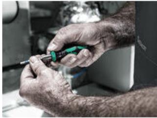
Mécanisme de cliquet intégré au manche
