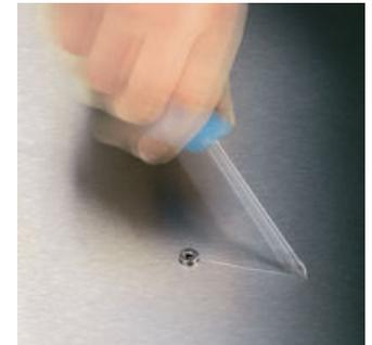
Riper hors de la vis est chose courante lors du vissage. Il arrive même que l'on endommage au passage des surfaces coûteuses, voire que l'on se blesse. La pointe des tournevis Wera Lasertip fait l'objet d'une découpe striée microscopique par rayon laser. Cette surface rugueuse vient littéralement "mordre" dans la tête de vis. Fini les dérapages intempestifs !
