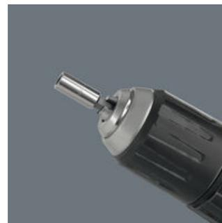
Porte-embouts universel pour l'admission d'embouts à emmanchement hexagonal 1/4". Douille en acier inoxydable pour une protection anticorrosion spéciale. Le jonc d'arrêt garantit le maintien optimal de l'outil dans le manche. Le puissant aimant permanent permet un maintien des embouts à toute épreuve. Pour visseuses avec admission selon DIN ISO 1173-F 6,3.
