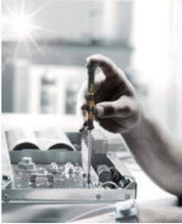
Aucune décharge électrostatique ne doit se produire lors du vissage de composants électroniques (comme dans les smartphones ou les tablettes), puisqu'il risque de s'ensuivre des dysfonctionnements, voir des pannes. Des outils de vissage antistatiques s'avèrent donc indispensables.
