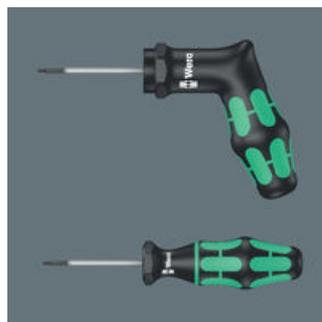
Les indicateurs de couple Wera sont pré-réglés en usine sur les valeurs recommandées par les grands fabricants d'outils coupants. Pour les profils TORX®, TORX PLUS® et six pans creux, ces couples se réfèrent à la taille respective des vis. Les indicateurs de couple permettent des assemblages par vis sûrs et faciles à desserrer. Précision :  $\pm 10\%$
