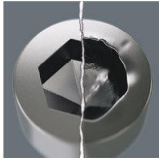
Le problème des vis à six pans creux tient à la finesse des surfaces d'appui sur lesquelles s'opère la transmission de la force depuis l'outil. Résultat : la tête de vis peut être endommagée. Les outils Hex-Plus possèdent des surfaces d'appui plus larges qui empêchent ce problème. Le couple transmis peut être jusqu'à 20 % plus élevé. Bon à savoir: les outils Hex-Plus s'utilisent sur toutes les vis à six pans creux standard !
