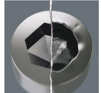
Le problème des vis à six pans creux tient à la finesse des surfaces d'appui sur lesquelles s'opère la transmission de la force depuis l'outil. Résultat : la tête de vis peut être endommagée. Les outils Hex-Plus possèdent des surfaces d'appui plus larges qui empêchent ce problème. Le couple transmis peut être jusqu'à 20 % plus élevé. Bon à savoir : les outils Hex-Plus s'utilisent sur toutes les vis à six pans creux standard !
