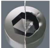
Le problème des vis à six pans creux tient à la finesse des surfaces d'appui sur lesquelles s'opère la transmission de la force depuis l'outil. Résultat : la tête de vis peut être endommagée. Les outils Hex-Plus possèdent des surfaces d'appui plus larges qui empêchent ce problème. Le couple transmis peut être jusqu'à 20 % plus élevé. Bon à savoir: les outils Hex-Plus s'utilisent sur toutes les vis à six pans creux standard!
