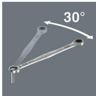
La forme dodécagonale de l'extrémité de la fourche permet de réduire à 30° l'angle de reprise de la Joker 6007. La Joker 6007 est dotée d'une fourche droite, ce qui évite de devoir la tourner et la repositionner.
