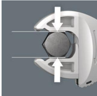
Les mors parallèles lisses de la clé double fourche Joker 6006 exercent une pression de surface et empêchent ainsi l'arrondissement de l'écrou ou de la tête de la vis susceptible de se produire lorsque la force est transmise par les angles.
